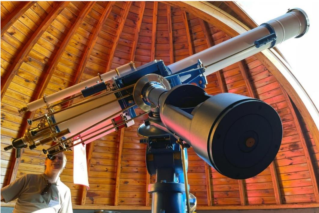
Der 7"-Refraktor (Typ Fraunhofer) von Carl Zeiss besitzt eine Brennweite von 2590 mm und ist mit einer mechanischen Nachführung ausgerüstet.
